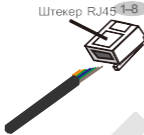
Малюнок 3.21 Зніміть шар ізоляції та підключіть до штекера RJ45
